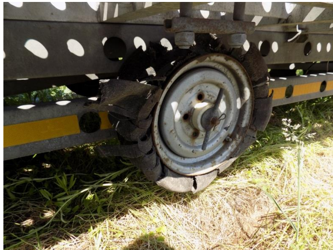
2. PRIKOLICA BOMAD – oštećena rez. guma
