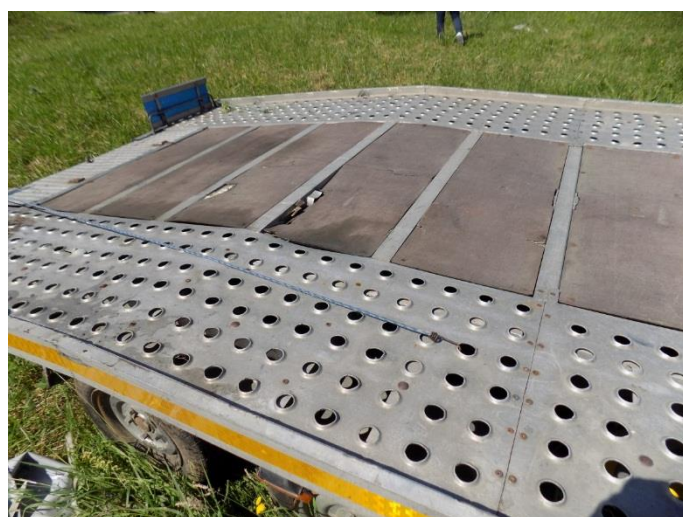
4. PRIKOLICA BOMAD – oštećenje platforme
