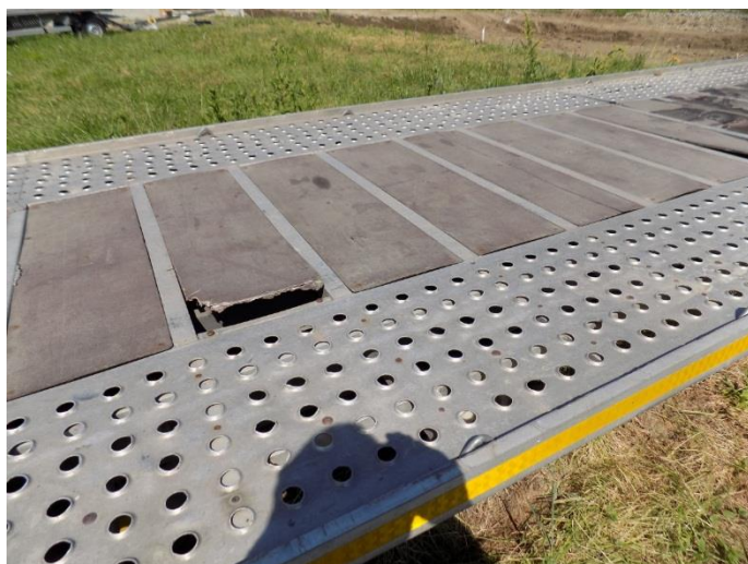
3. PRIKOLICA BOMAD – oštećenje platforme
